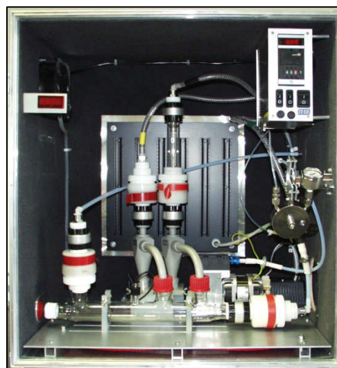
Detail třídících prvků aparatury VAPS (E)
