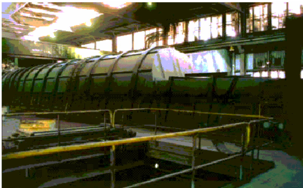
Obrázek 2 - Zakrytý aglomerační pás podle EOS procesu (Panne, 1991)
