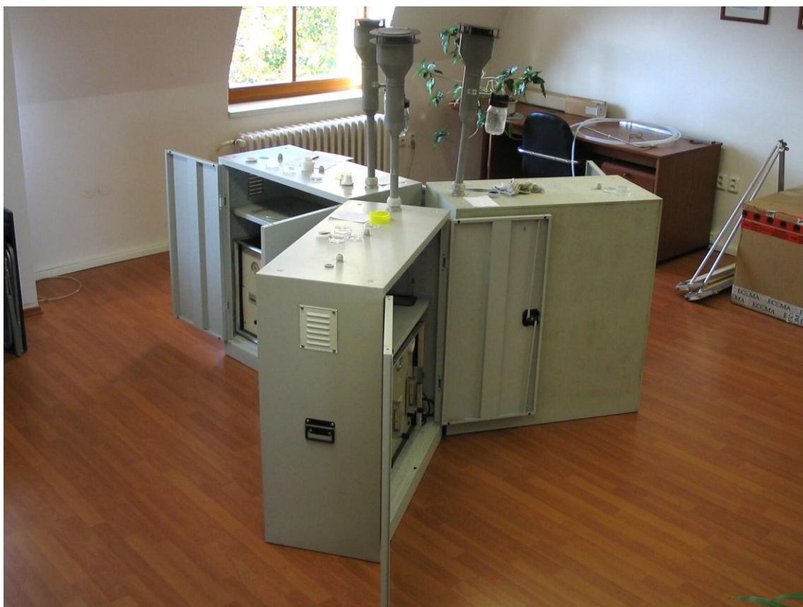
Obrázek 5 - Uspořádání tří aparatur VAPS (I) při párovém měření
