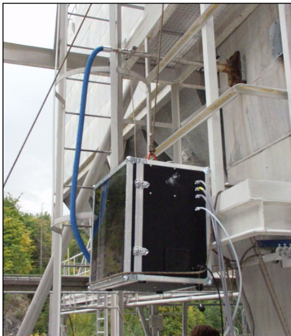
Odběr vzorku z potrubí do manifoldu vzorkovače
