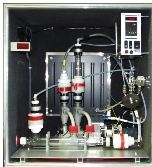
Detail třídících prvků aparatury VAPS (E)
